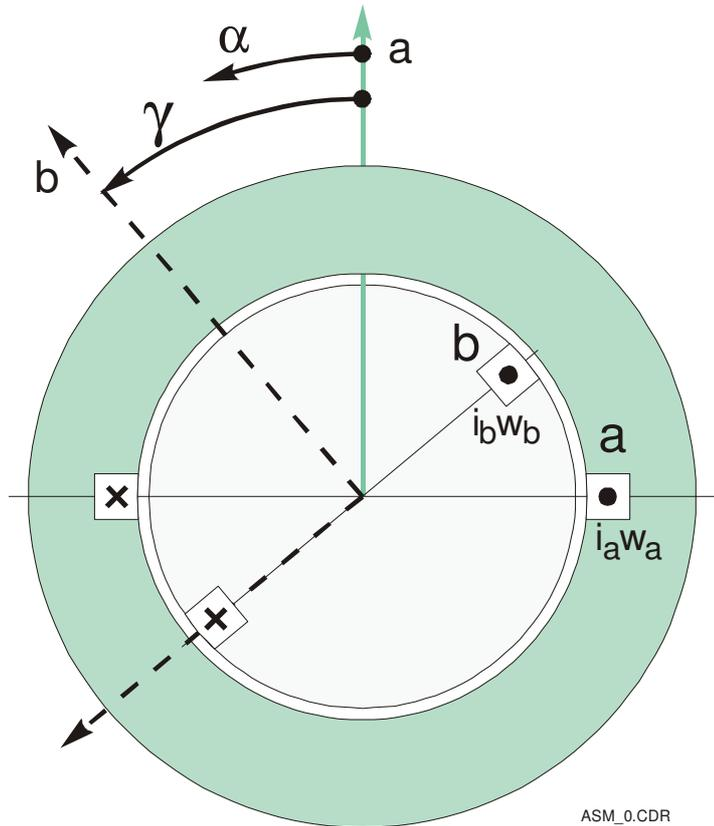
Zweispulenmodell mit je einer Spule im Stator und Rotor
